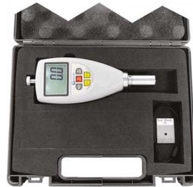
Tipo digitale con ampio e chiaro display multifunzione per misurare la durezza di acciai, ghise, alluminio, materiali non ferrosi. Trasportabile per la massima flessibilità e mobilità d'uso, con sensore a rimbando, separato, che permette semplici misurazioni anche in posizioni di difficile accesso. Utilizzo in tutte le direzioni (360°) con compensazione automatica dell'angolo. Conforme alle norme ASTM A-956 e DIN 50156.
